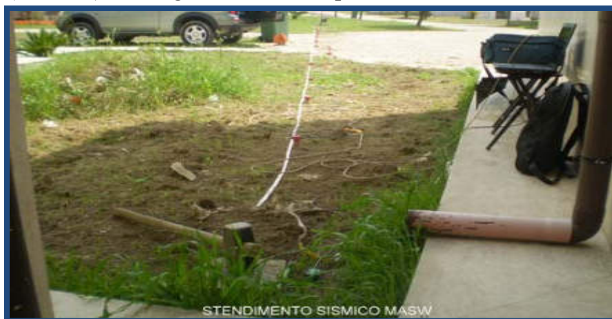
Figura 2: ESEMPIO DI STENDIMENTO SISMICO
