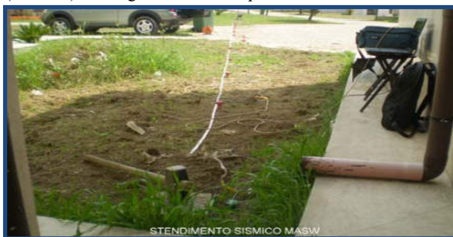
Figura 2: ESEMPIO DI STENDIMENTO SISMICO
