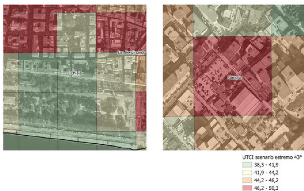
fig.5.3.6 Dettaglio cella di rilevamento isole di calore
