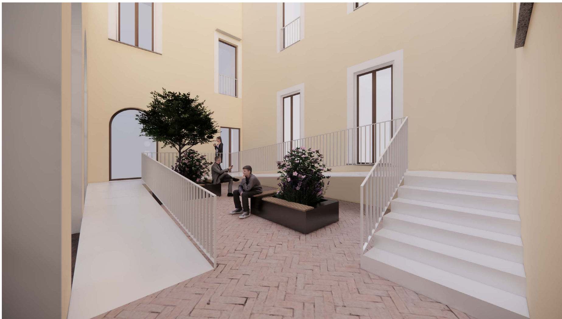
Cortile interno - allestimento per il superamento barriere architettoniche
