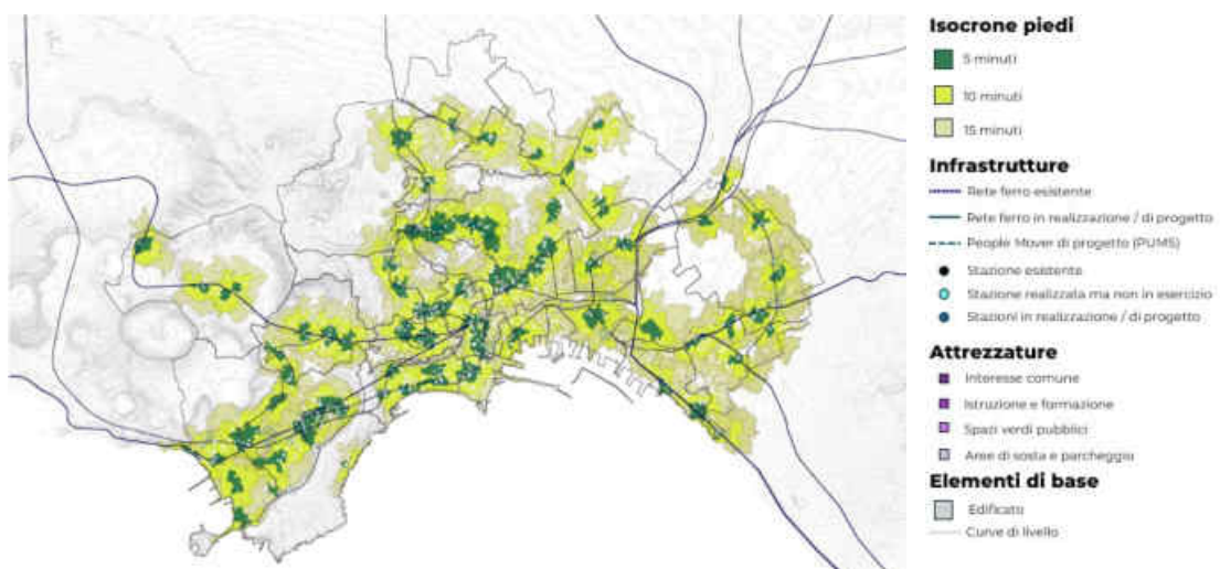
Fig. 9 | Isochrone piedi a partire dai nodi della rete ferro esistente e programmata
