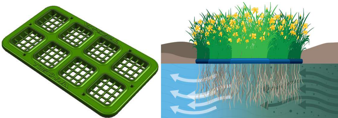
Figura 5.1 - Elemento Tech-IA e schema di processo fitodepurativo
