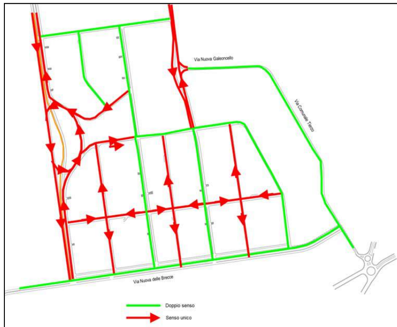
Figura 2.22 - Schema di circolazione alternativo 96ha (in rosso i rami a senso unico di marcia)
