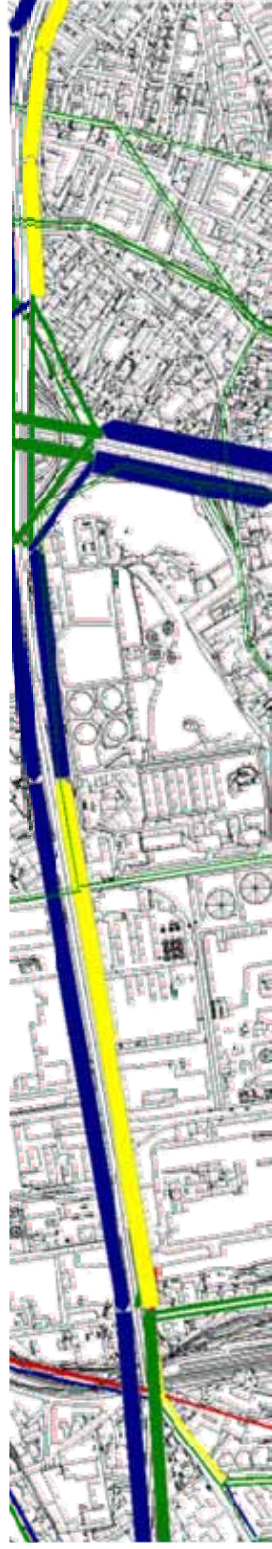
Figura 3.1.2 – Distribuzione dei flussi e relativo grado di congestione sulla rete stradale dell'area di intervento – scenario attuale. Ora di punta della sera
