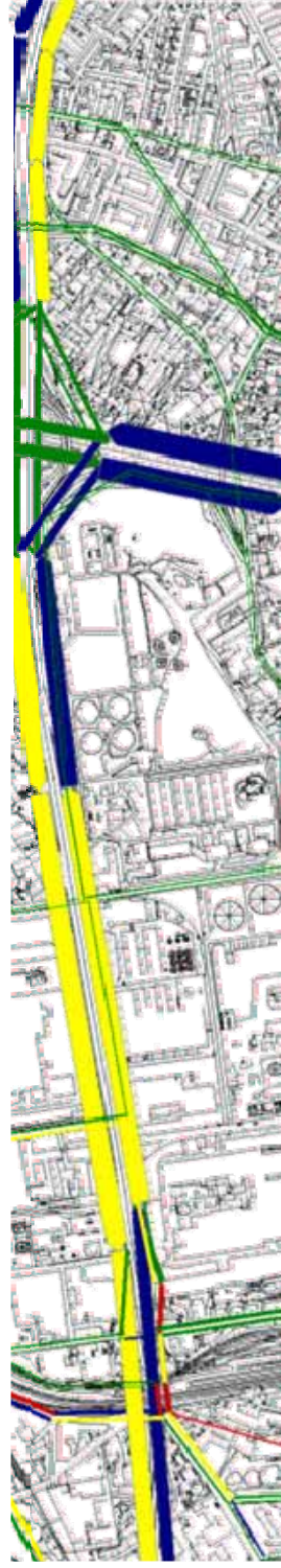
Figura 6.3 – Distribuzione dei flussi veicolari e relativo grado di congestione. Scenario di progetto. Ora di punta della sera. Giorno feriale
